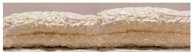
(a) (b) 図 3 ウレタンスポンジの体積の比較 (a) 圧縮時 (b) 非圧縮時
