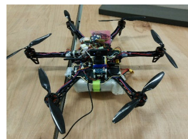
図 6 鳥獣被害対策 監視・防除 UAV 全体図 Figure 6 Overview of Monitoring and Prevention UAV
