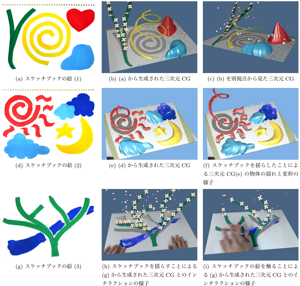
図 9 「不思議なスケッチブック」による三次元 CG 生成とインタラクションの例 Fig. 9 Examples of generating 3DCG objects and interaction with them on the “Amazing Sketchbook”.
