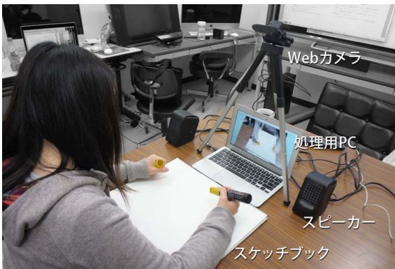
図 1 「不思議なスケッチブック」のシステム構成 Fig. 1 The components of “Amazing Sketchbook”.
