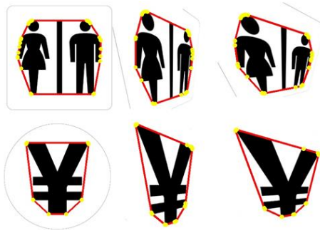
図8 参照画像（左）と射影変換画像（真ん中、右）の凸包コーナー検出
