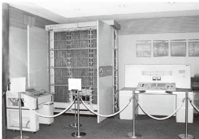
図-3 東北大学に納入したコンピュータ (SENAC-1/NEAC-1102 情報処理技術遺産)
