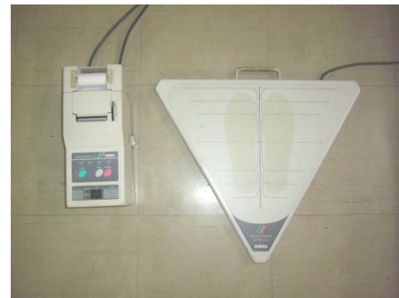
図2 重心動揺計(GS-10, アニマ社) Figure 2 The stabilometer (GS-10, Anima).
