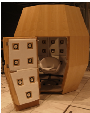
図 1 実験に用いた 3 次元音場再現システム (音響樽) Figure 1 The 3-D reproduction sound field system (the Sound Cask)
