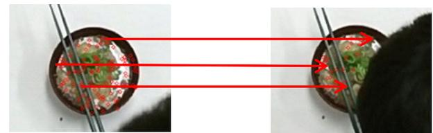
図 8 SIFT 追跡における特徴点マッチングの例 (赤い円は特徴点、矢印はマッチング先の特徴点を示す)
