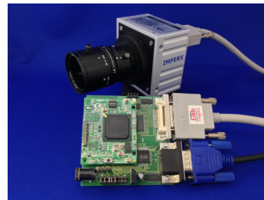
図 4 開発した高速カメラと FPGA によるカメラシステム
