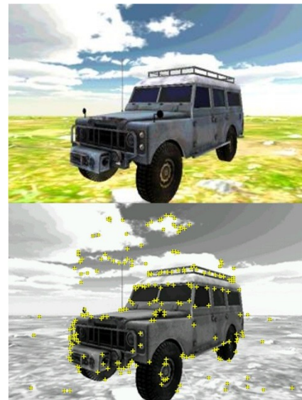
図2 Vuforiaでの特徴点検出
