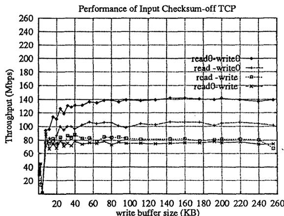
通常の TCP 通信と同じ傾向だが、read0-write0の組合せの性能が更に向上し、read-writeの組合せより
