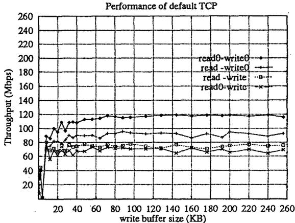
0-copy 通信の read0-write0の組合せが、最も高速であり、普通の read-writeの組合せより、54% 向上し、120Mbps のスループットに達している。
