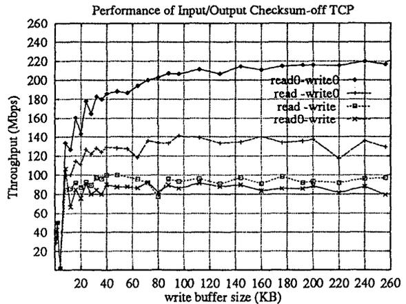
更に顕著な性能向上が見られ、read0-write0の組合せで 218Mbps のスループットを達成している。
