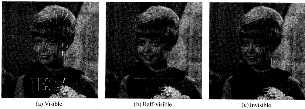
図 6 StirMark 攻撃による不可視化結果の影響 Fig. 6 Effect on invisualized marks by StirMark attack.
