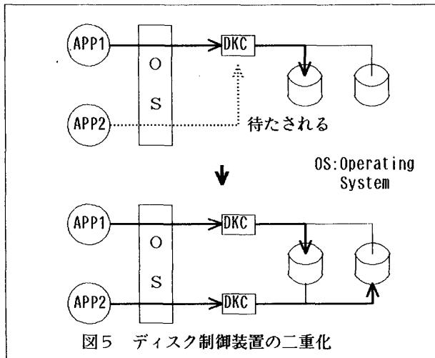
第2に、ディスク制御装置の故障はシステムへの影響が非常に大きく、接続されている全てのディスク装置が使用できなくなる。従って、ディスク制御装置を二重化することにより片方のディスク制御装置が故障したとしても、もう一台のディスク制御装置を使用してデータ転送することができる（縮退運転）ので、制御装置に関しても信頼性を向上させることができる。
