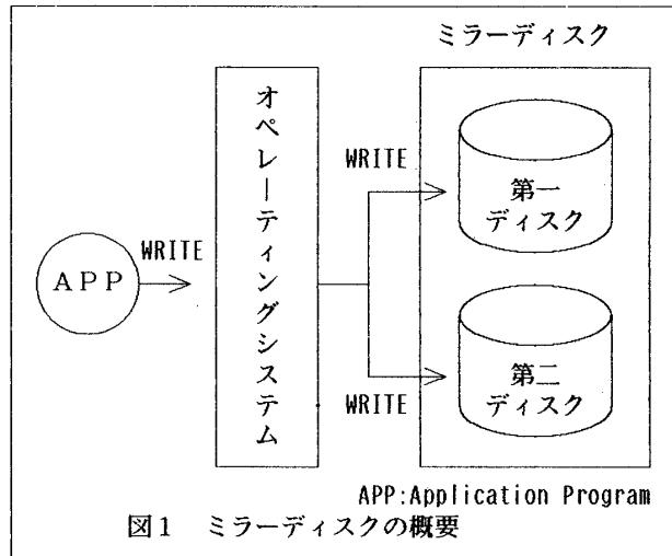
③ ディスク装置の二重書きによる性能低下を極力おさえる為に、ディスク装置のリード処理の効率化とディスク制御装置の二重化を行っている。
