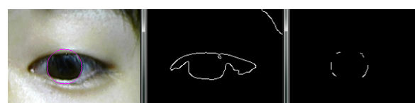
図 9 虹彩が下側に位置する場合の実験画像 (左:元画像, 中:エッジ抽出, 右:虹彩円周上のエッジ)
