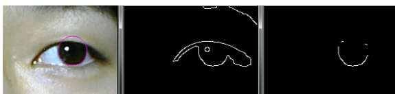
図 13 虹彩が外側に位置する場合の実験画像 (左:元画像, 中:エッジ抽出, 右:虹彩円周上のエッジ)
