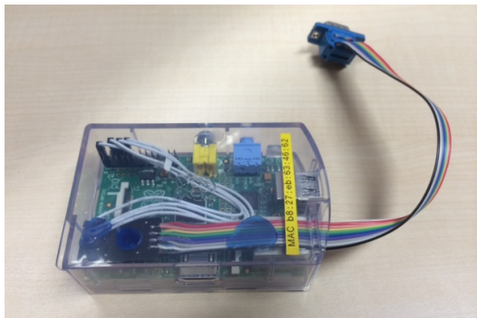
図 2 Raspberry Pi を利用したサイネージ表示デバイス Figure 2 Signage Viewer Device using Raspberry Pi.
