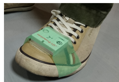
図 5 靴に搭載されたセンサ
