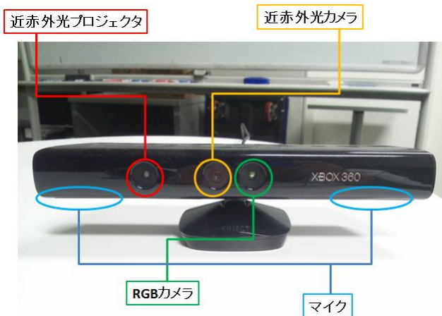
図7 Kinect センサの外観とセンサ類。
