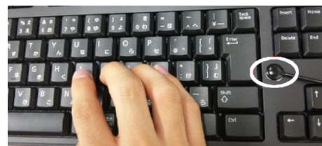
図2: キーボードに装着したピエゾピックアップ
