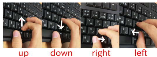
図1: キートップの引っ掻き方
