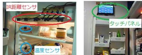
図1 設置した各種センサとタッチディスプレイ
