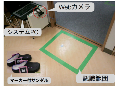
図 3: マーカー認識型位置検知システム
