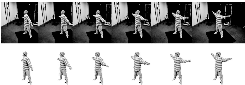
図 9 (上) 原画像と (下) 生成された自由視点画像 Fig. 9 Camera images (upper) and generated images (lower).
