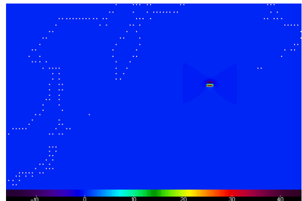
図 3 太平洋上での地震により発生した波の初期状態の高さ
