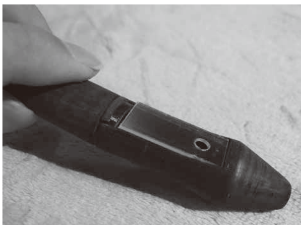
図-9 プラ板を用いた平面製作の一例。 平面に透明アクリル板をはめ込み、次の研磨加工を省略する
