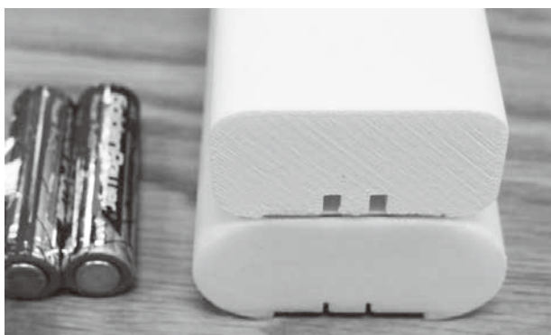
図4 体験検証プロトタイプでの作りこみの一例、グリップ部の厚みを数 mm 単位で変えて検証した
