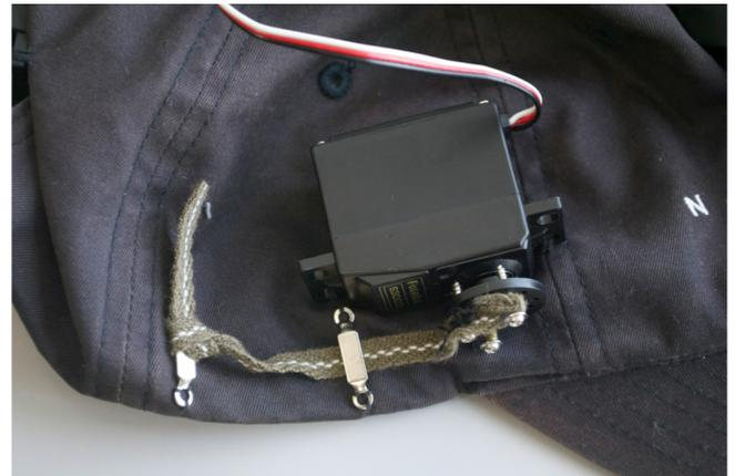
図 2 圧力発生機構の外観
