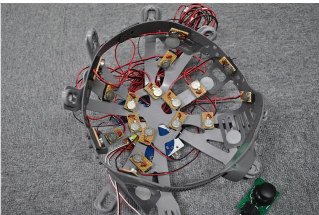
図 4 振動モータを使用した全天型モデルのデバイスイメージ
