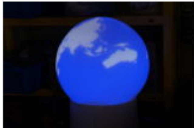
図 4 地図を投影した球面ディスプレイ Figure 4 Map Projection on Sphere-Shaped Display.
