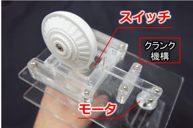
図 3 デバイスの構造
