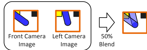
図8 画像合成 ( \alpha ブレンディングする場合) Figure 8 Image Synthesis (Alpha Blending)
