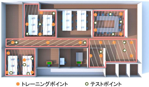
図 2 実験を行ったフロアの見取り図 (29.8m × 16.3m).
