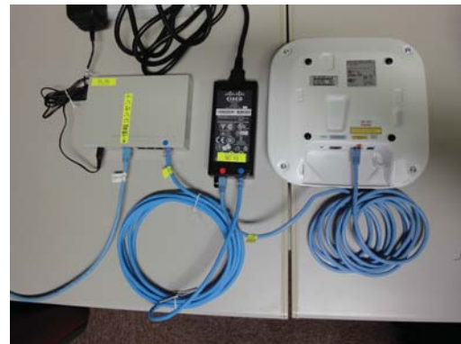
図 8 可搬型アクセスポイント関連機器の接続方法
