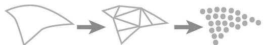
図2 境界の分解。1段階目では2次元曲面境界を2次元平面境界に分解する。2段階目ではさらに離散境界に分解する
