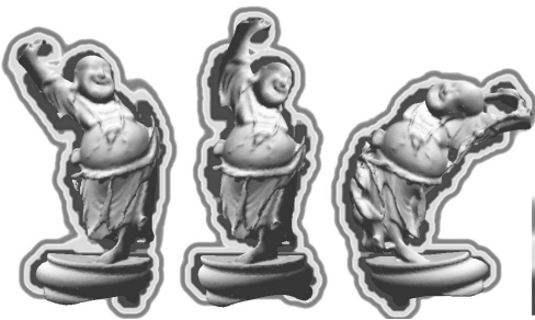
図4 計算された距離関数. ある面の距離関数を値によって色で示す. 距離関数は図右下のカラーバーのように距離は色づけされている Fig. 4 Calculated distance function. This figure shows a distance function at a slice. The distance function is colored with color shown at the bottom right.
