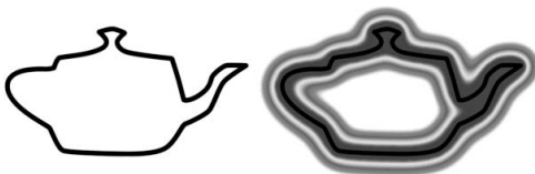
図1 境界(左)と距離関数(右)。右図は距離関数を色で表しているものである
