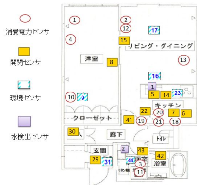
図 4 スマートハウスの図面と各センサの配置
