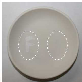
図 5 左側破線部(分散前):ガラス蛍光体の層が厚いため塗布した部分が視認できる。右側破線部(分散後):ガラス蛍光体の層が薄くなるため視認しにくいのがわかる。
