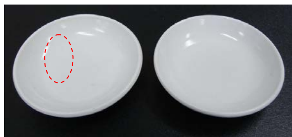
図 6 左側:ガラス蛍光体を溶着させた皿(破線で囲っている部分にガラス蛍光体が溶着している)。右側:ガラス蛍光体を溶着させていない皿。
