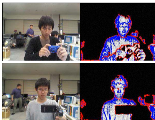
図 11 カメラの保持を検知できたケース(上)と検知できなかったケース(下)。Kinect との距離が短すぎるため、カメラと手の部分の距離情報が欠落しているのがわかる。
