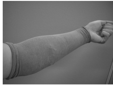
図 2 試作した袖部分の導電性衣服の裏側 Fig. 2 Inner wear of fabricated conductive sleeve.
