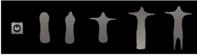
図 6 実験で用いた模型とスピーカー。左から Sp (スピーカー), T (胴体のみ), TH (胴体+頭), THA (胴体+頭+腕), THA1L (胴体+頭+腕+1脚), THA2L (胴体+頭+腕+2脚)
