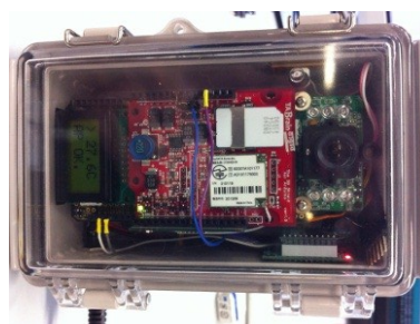
図 4 無線センサネットワーク親機デバイス
