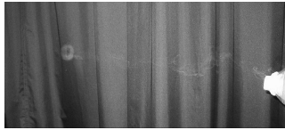
図1 空気砲から発射された渦輪が飛行する様子 Fig.1 A vortex ting launched from an air cannon.
