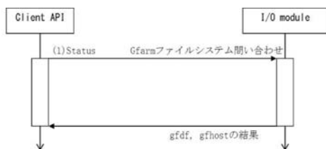
図 6 ステータス収集処理のフロー Fig. 6 Flow of the status collection process.
