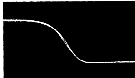
第4図 入力パルスと出力パルスの比較 振幅 0.75\text{V} 、掃引 0.02\mu\text{s/cm}
