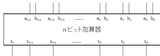
図 3 n ビット加算器の概略 Fig. 3 Brief of n bit adder
