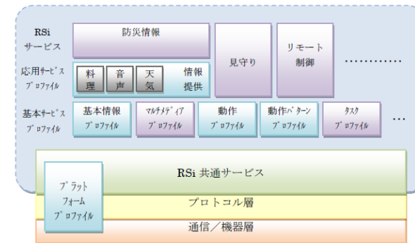
図2 RSNPのシステムアーキテクチャ Figure 2 System architecture of RSNP
