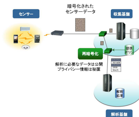
図 1: 再暗号化方式の構成
