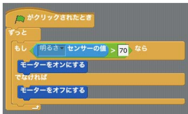
図3 センサーの値とモーター制御を組み合わせたプログラム例
