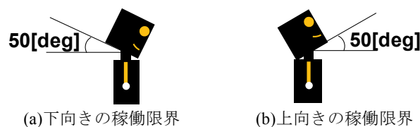
図5 ロボットアバタの頭部の動作範囲
