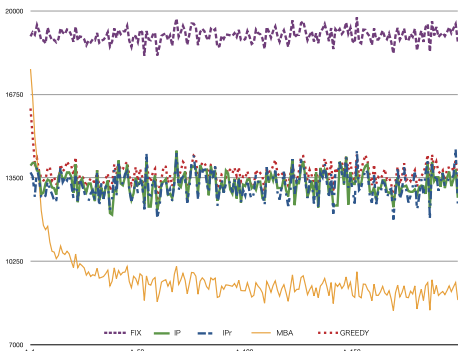
図 2 物理計算機数 (=VM 数)250 のときの FIX, MBA, GREEDY, IP, IPr の消費電力量の推移
