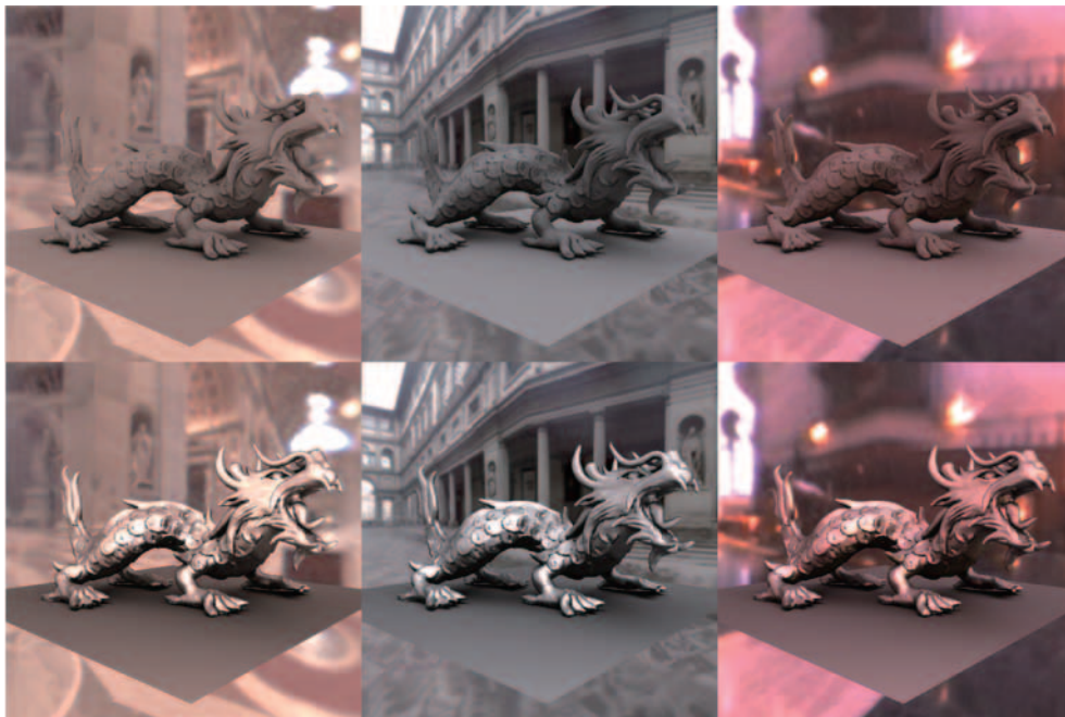
図-3 球面調和関数を用いた PRT 法による結果画像。上段は BRDF として拡散反射を、下段は光沢反射を用いている。
