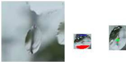
図 7 ある雨滴 (左) と、球体モデルを使った場合 (中) および回転楕円体モデルを使った場合 (右) の人工雨滴画像。 赤・青・緑に塗られている領域は、背景領域に対応する画素がなかったため、類似度の計算には使わない領域。 Fig. 7 Simulated raindrop images derived from the sphere model and the spheroid model.
