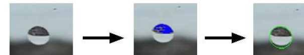
図6 候補領域の抽出。画像(左)からMSERの領域検出を行い(中)、楕円領域を当てはめる(右)。
