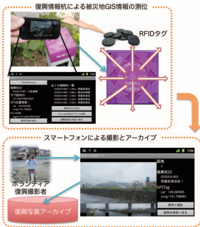
図-4 スマートフォンを用いたデジタルアーカイビング補助システムの概要
