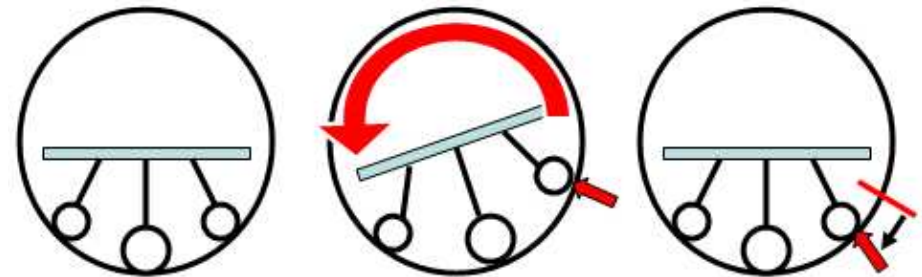
図 12 自重によるロールとピッチ方向回転に対する姿勢意維持
