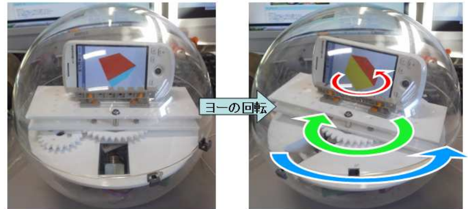
図 14 ヨー方向に対するデバイスの動作
