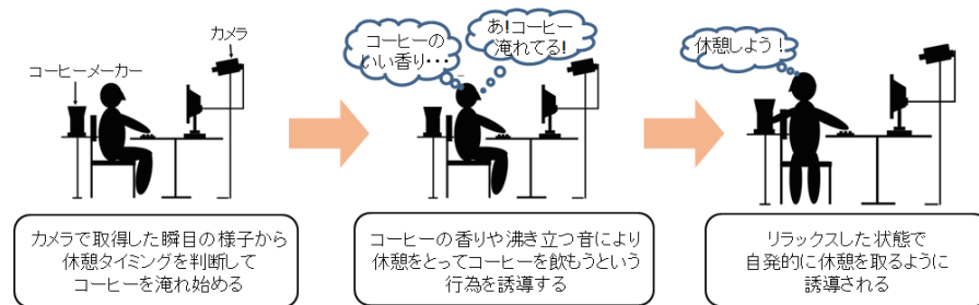
図 7 コーヒーメーカーを利用した休憩タイミングの提示手法
